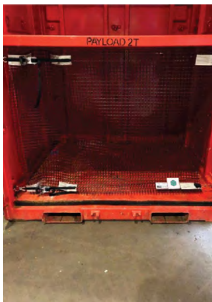
Bilde 13: Nedre Nett Montert og Oppstrammet
