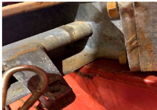
Bilde 4: Demontering / montering av karabinkrok
