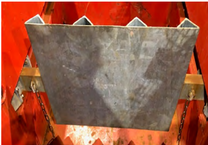
Bilde 7: Endevegg løsnet før flytting
