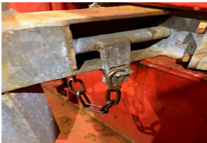
Bilde 1: Håndtak høyre side, i låst posisjon med karabinkrok
