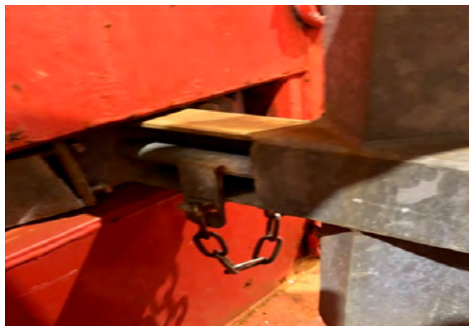
Bilde 2: Håndtak venstre side, i låst posisjon med karabinkrok
