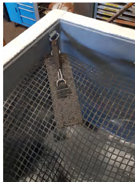
Bilde 21: Nærbilde av nett oppspent i ett hjørner
